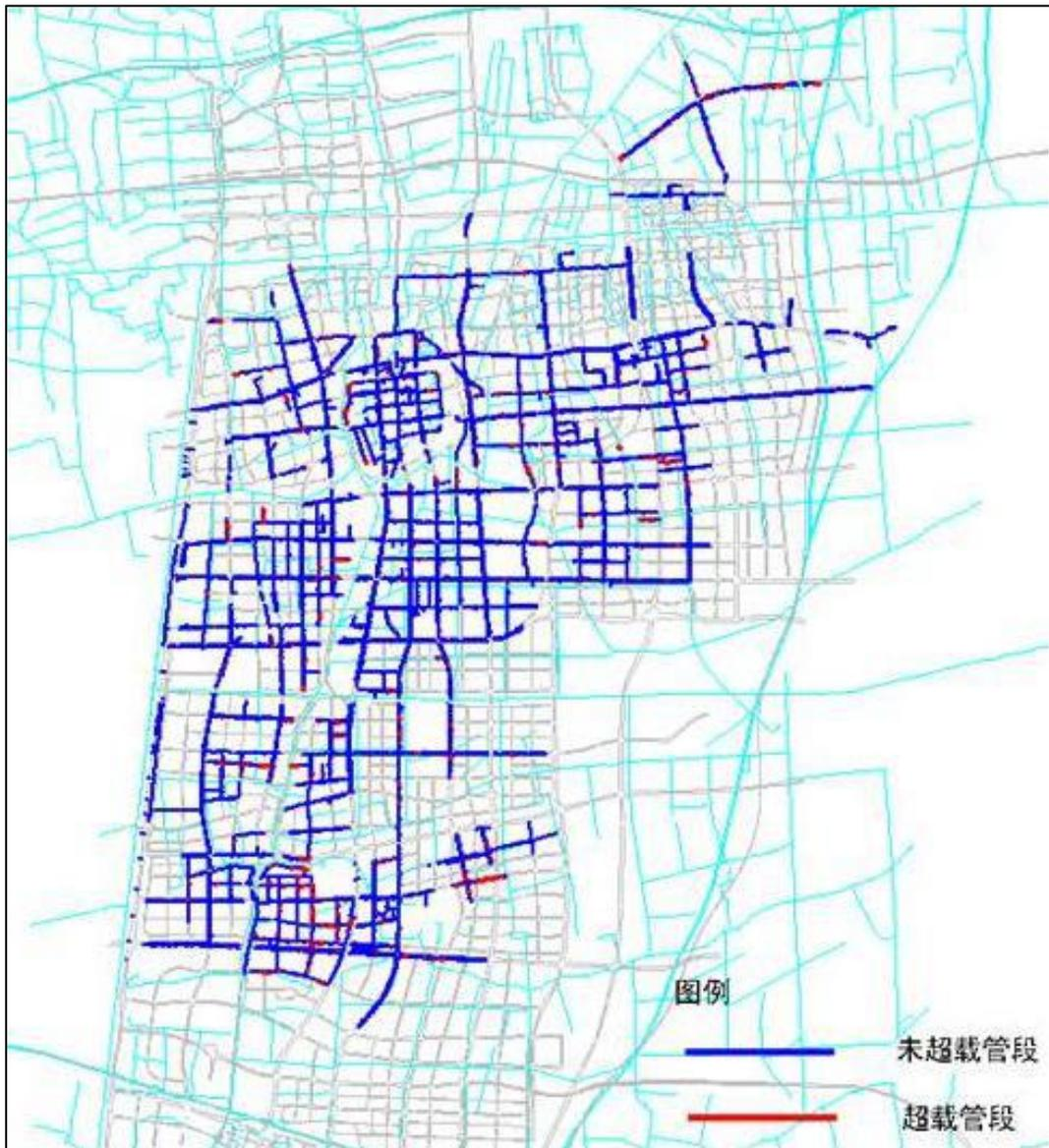
主城区已建管道水力状态示意图（ $p=1$  年设计雨型）
